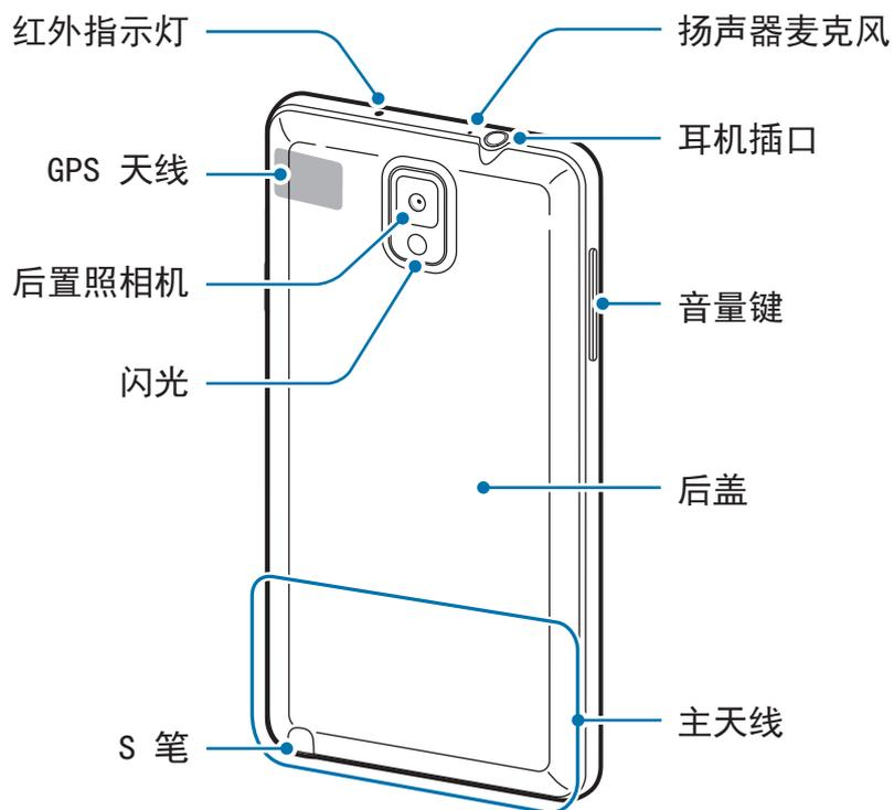
设备顶端的麦克风仅在使用扬声器或拍摄录像时启动。
