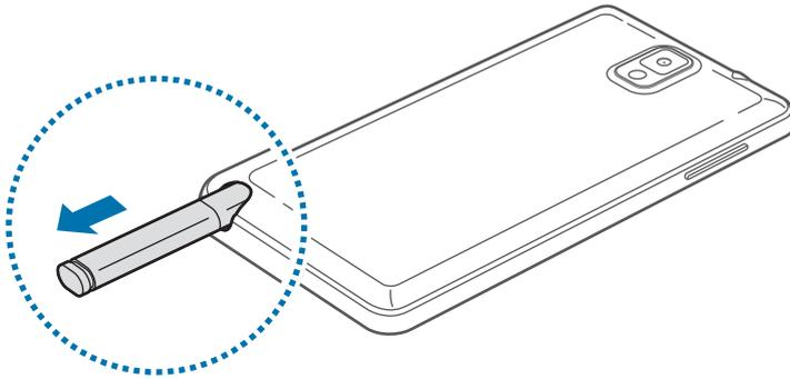
从插槽拔出 S 笔时，设备将检测触控笔并执行以下操作：
