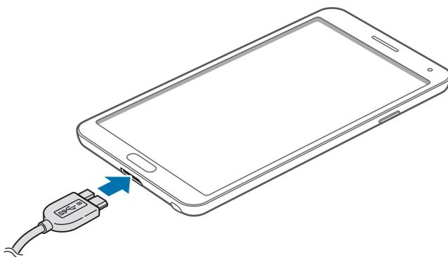
当使用 USB 2.0 数据线时，按照下图所示将 USB 数据线插入多功能插孔的右侧。
