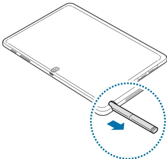
從插槽中拉出 S Pen 時，裝置將偵測 S Pen 並執行以下操作：
