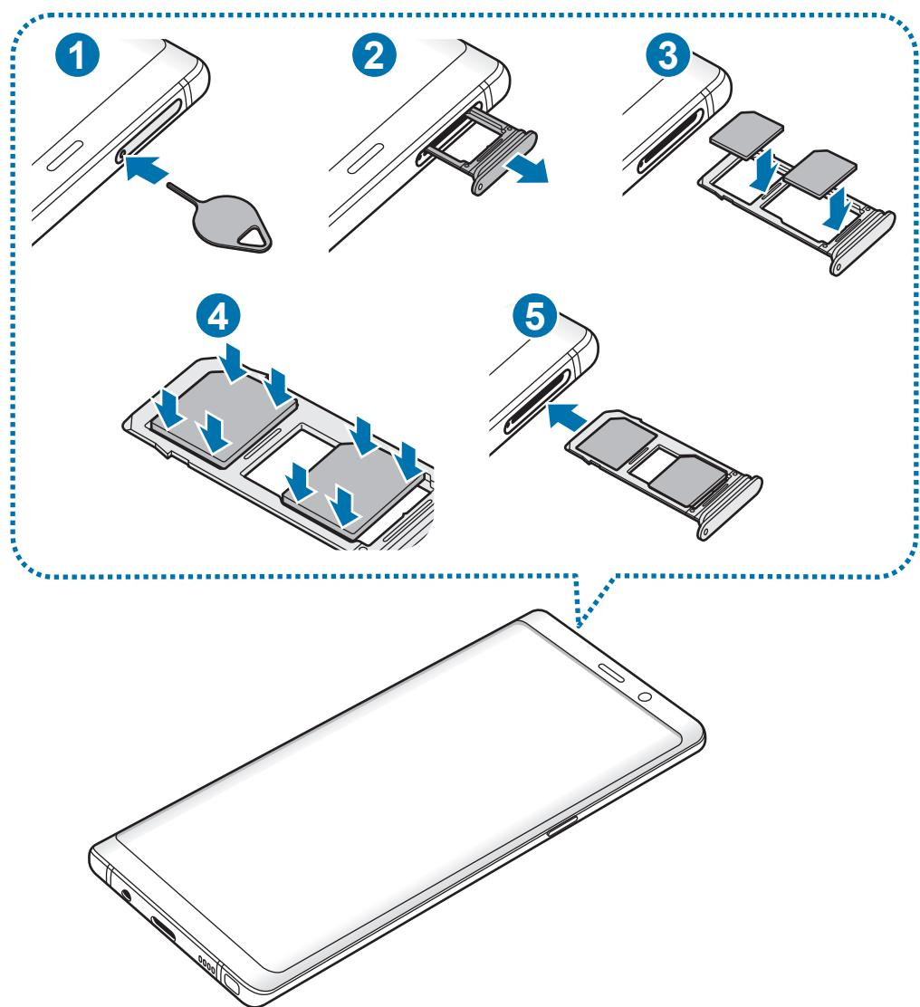
1 将卡针插入卡托上的小孔弹出卡托。
