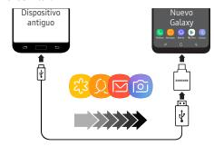
**Nota**: La opción USB debe estar establecida como un dispositivo multimedia (MTP) en el otro dispositivo. La transferencia de contenido con un cable USB pudiera aumentar el consumo de la batería. Asegúrese de que la batería esté completamente cargada.
