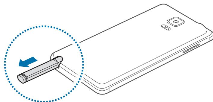
Kada uklanjate S olovku iz utora, uređaj pokreće **Aktivna Bilješka** ili prikazuje funkcije zračne naredbe ovisno o opciji izvlačenja S olovke.
